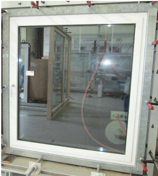
Bild 1 Probekörperansicht auf Prüfstand Fenster geschlossen
