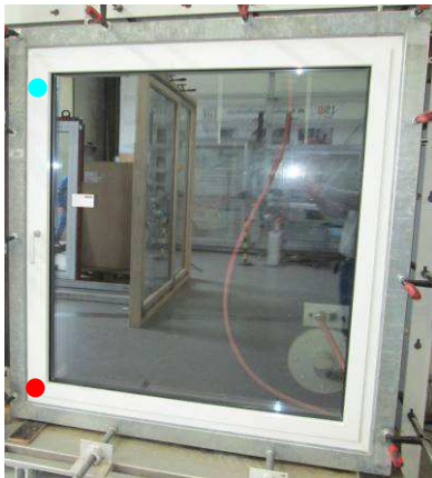
Bild 7 Positionsplan der Verriegelungen
