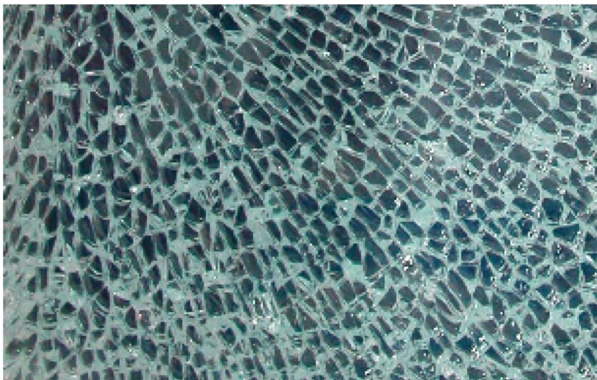
Crtež br. 31. Primjer strukture loma na površini kaljenog stakla debljine od 10mm.
