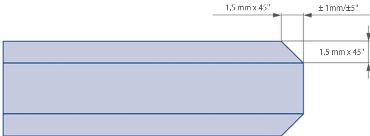
Crtež br. 4. Shema brušenog ili poliranog ruba stakla trapeznog oblika
