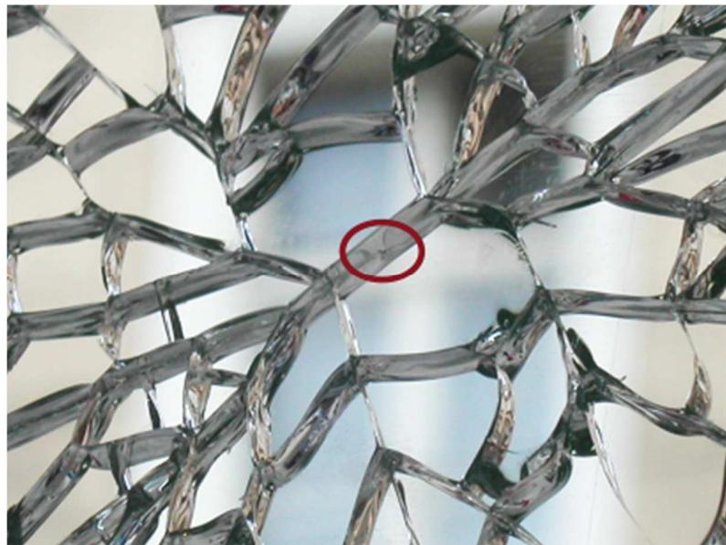
Crtež br. 30. Prikaz ispucanog stakla nakon spontanog loma prouzrokovanih niklovim sulfidom
